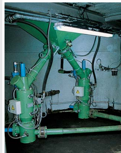
Sender 2 x SK 30/100; Förderleistung: 15 t/h Altsand
